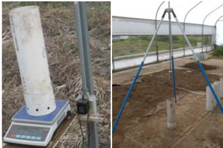
Figura15. Verificación de humedad alcanzada y medición de resistencia mecánica.
