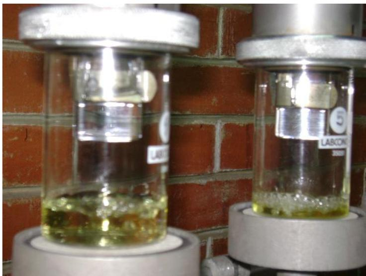
Figura 14A. Muestras de germen en proceso de extracción del aceite de la misma forma como se procedió para la extracción en grano completo hasta obtener el peso del residuo.
