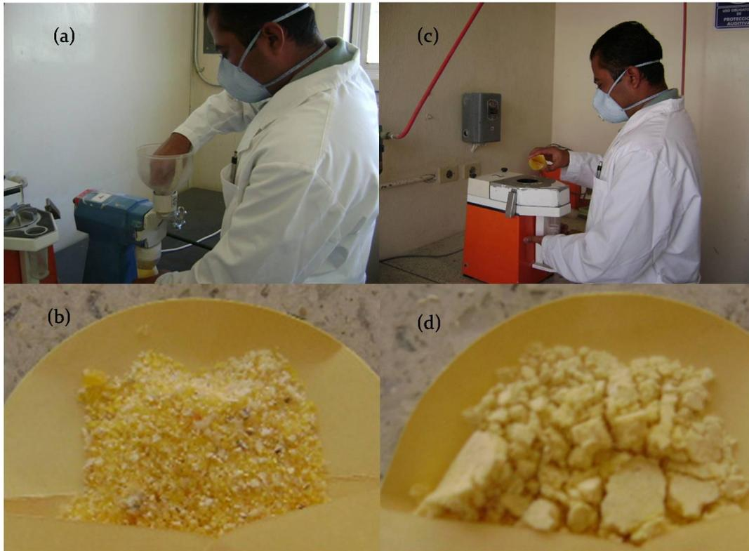
Figura 2A. Triturado de los granos (a), granos molidos en partículas grandes (b), muestra de grano premolida en (a) pasando en molino pulverizador (c), muestra pulverizada tamizada en malla 0.05 mm (d).
