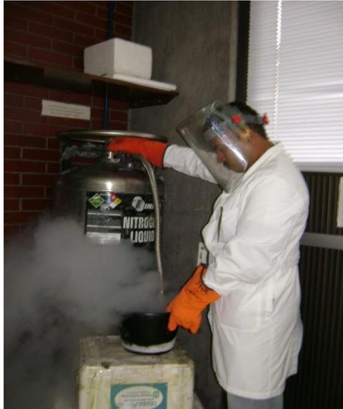
Figura 9A. Colocación del nitrógeno líquido en un contenedor.
