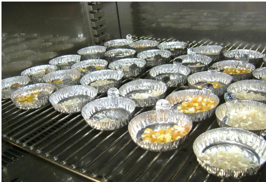
Figura 7A. Determinación del peso seco de las estructuras del grano en una estufa, sometiéndolos a una temperatura de 130°C durante una hora.
