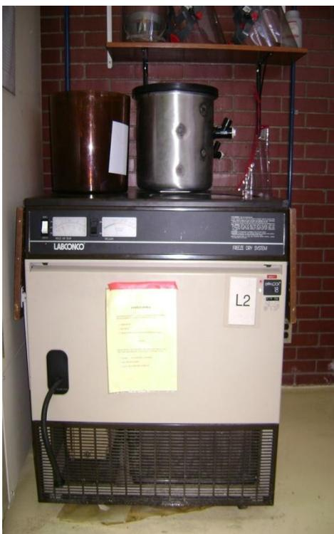
Figura 13A. Tubos con germen molido depositados en un liofilizador durante 72 horas con el propósito de eliminar el agua en las muestras y detener cualquier reacción metabólica por la presencia del mismo.
