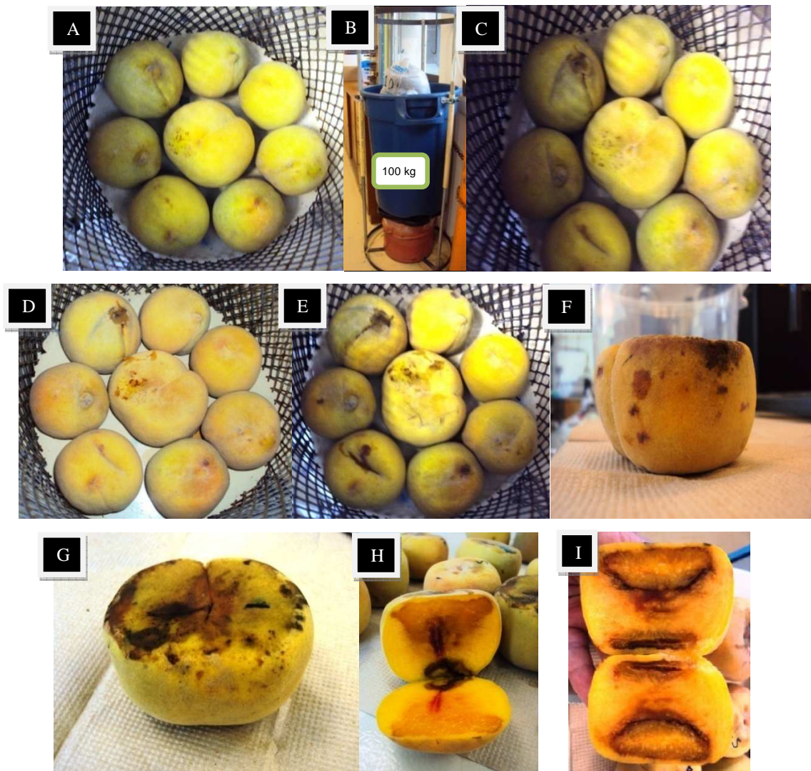
Figura 21. Durazno Oro de Tlaxcala, tratamiento 100 kg: A) acomodo de los frutos al iniciar el tratamiento, B) carga aplicada sobre los frutos, C) frutos al día 1, D) frutos al día 2, E) frutos al día 3, F) se muestra el aplastamiento de la zona polar del durazno por la carga aplicada, G) manchado exterior del fruto por carga y desjugue, H) manchado interno del fruto, I) oscurecimiento de la zona dañada por la carga.
