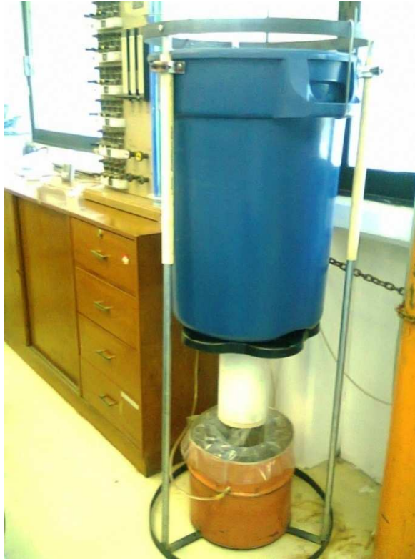
Figura18. Imagen real del aparato simulador de esfuerzos dinámicos.
