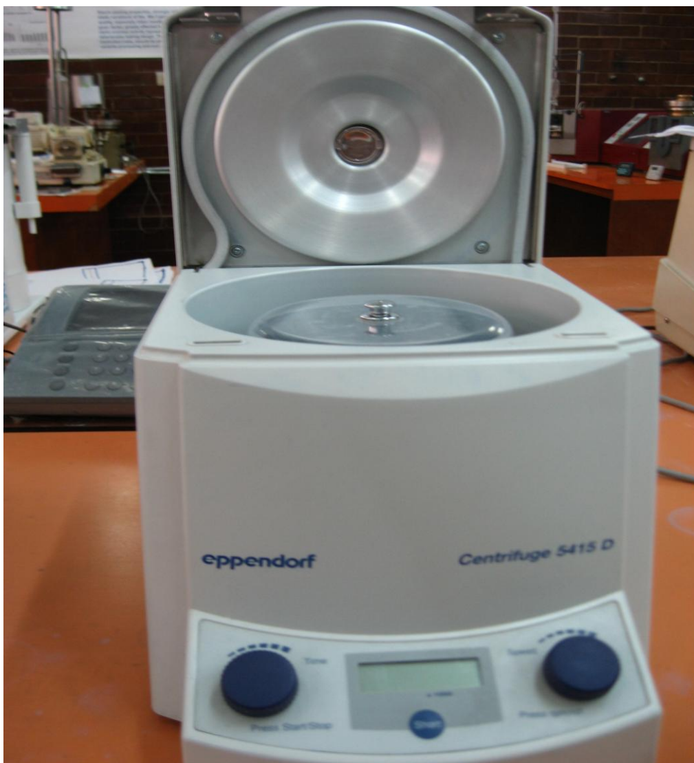
Figura 3A. Centrifuga empleada en el fraccionamiento y cuantificación de las proteínas.
