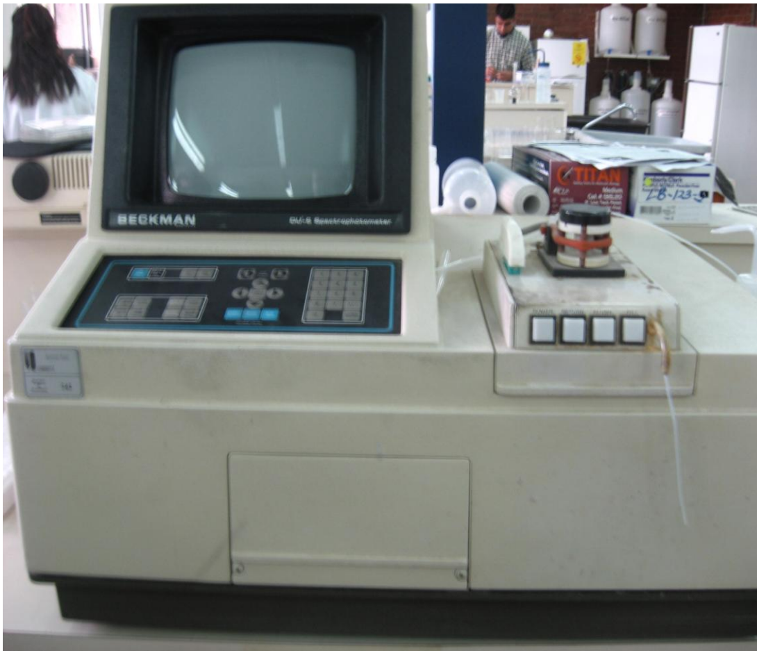
Figura 5A. Espectrofotómetro Beckman midiendo longitud de onda a 280 nm.
