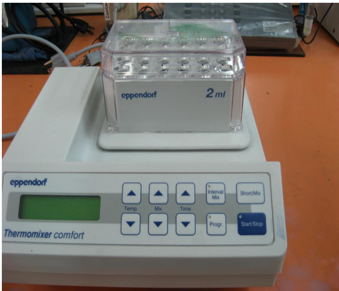
Figura 4A. Incubación realizada a temperaturas controladas en el Thermomixer Eppendorf (Eppendorf-Netheler, Hamburg, Germany).
