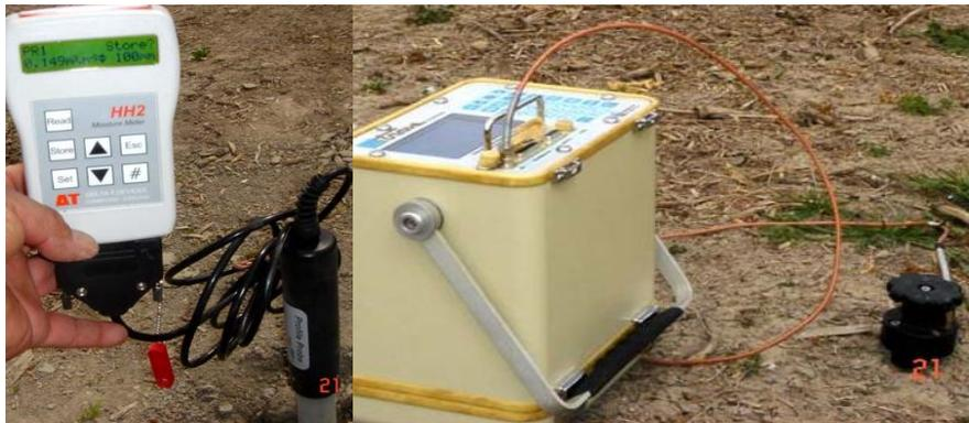
**Figura 4.5. Tipos de reflectometría de dominio del tiempo (TDR), para medir humedad.**
