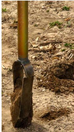
**Figura 4.4. Barrena para determinar la humedad del suelo.**
