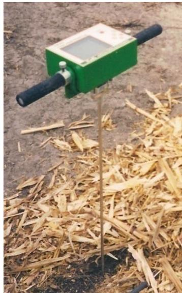
**Figura 4.6. Penetrómetro de ultrasonido (PU), para medir dureza del suelo.**
