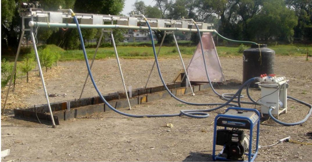
**Figura 4.8. Equipo de simulación de lluvia tipo ARS/USDA.**
