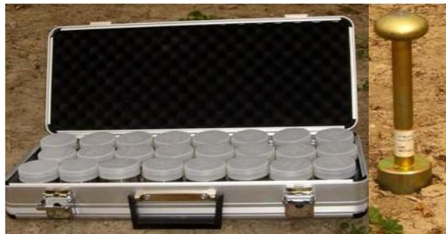
**Figura 4.3. Equipo para determinar la densidad aparente.**
