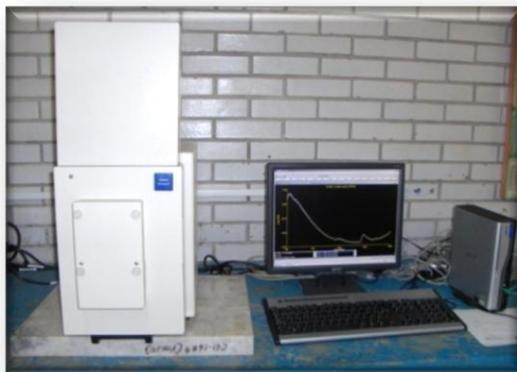
Figura 20. Espectroscopio de infrarrojo cercano, NIRs Versatile Agri Analyzer™ 6500.
