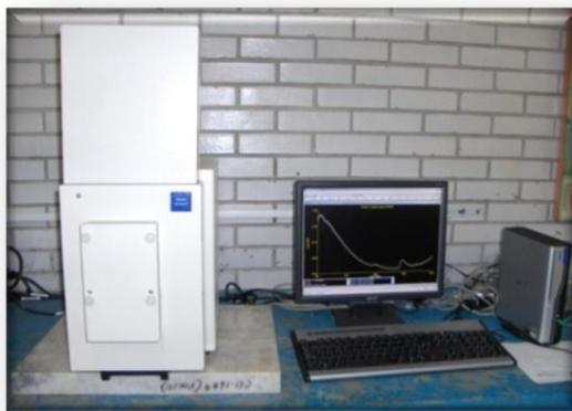
Figura 10. Espectroscopio de infrarrojo cercano, NIRs Versatile Agri Analyzer TM 6500.
