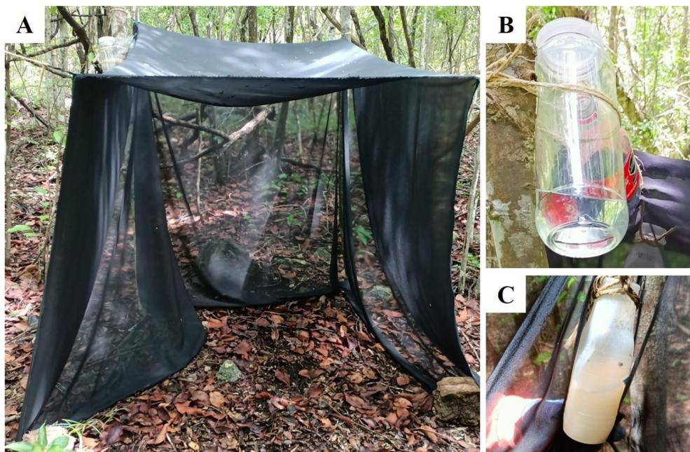
Figura 9. Estructura de la trampa de intercepción de vuelo de tipo Malaise para la captura de tabánidos. Panel A) Montaje de la trampa. Panel B) Colocación del frasco con etanol al 70 % para la preservación de los organismos. Panel C) Colocación de la solución atrayente.
