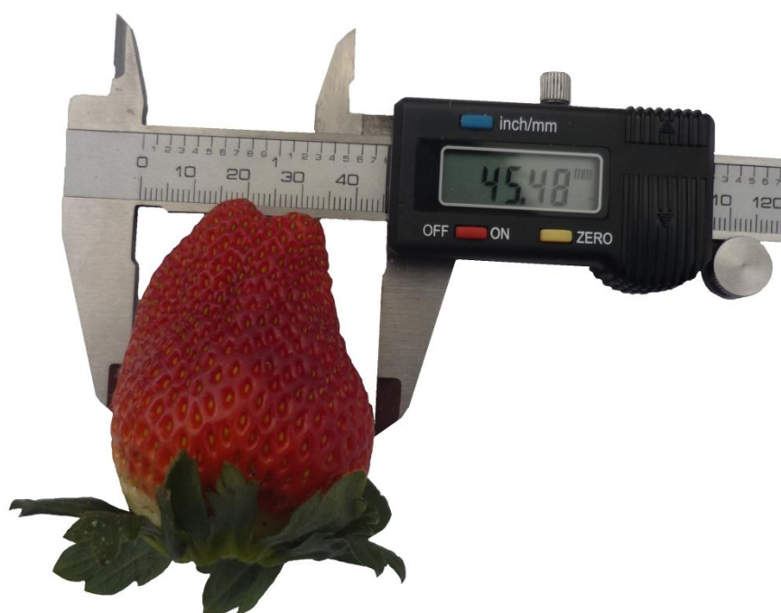
Figura 4. Medición de la fruta en su diámetro ecuatorial con el vernier TRUPER digital estándar y milimétrico de 6" (150 mm).
