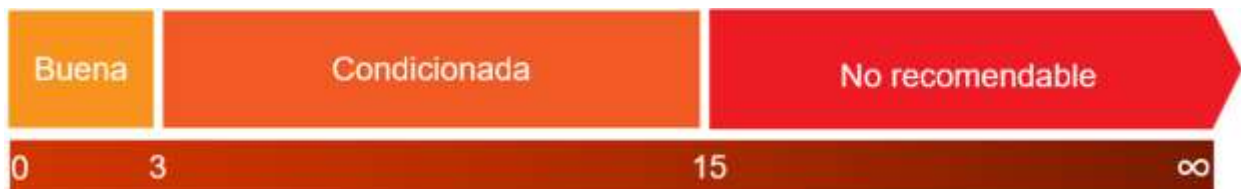
Figura 5. Clasificación del agua de acuerdo con el índice de salinidad potencial (SP).
