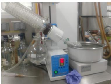
**Figura 20.** Rotavapor utilizado para eliminar el etanol de los macerados.
