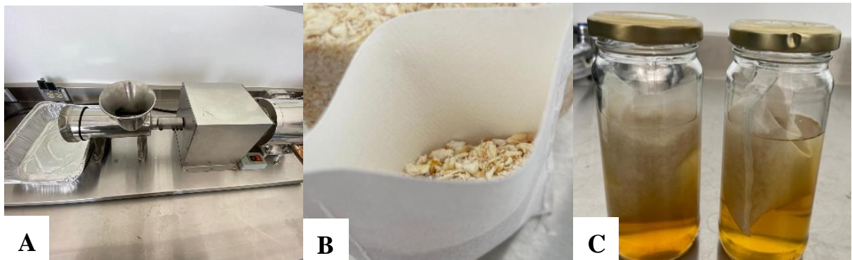
Figura 9. Preparación de muestra para macerados. A: Molino de acero inoxidable. B: Sobre de papel filtro con muestra. C: Muestra macerada en solución hidroalcohólica.
