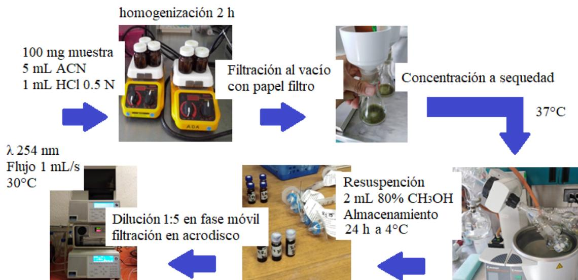
**Figura 2.6** Proceso de extracción de las isoflavonas.
