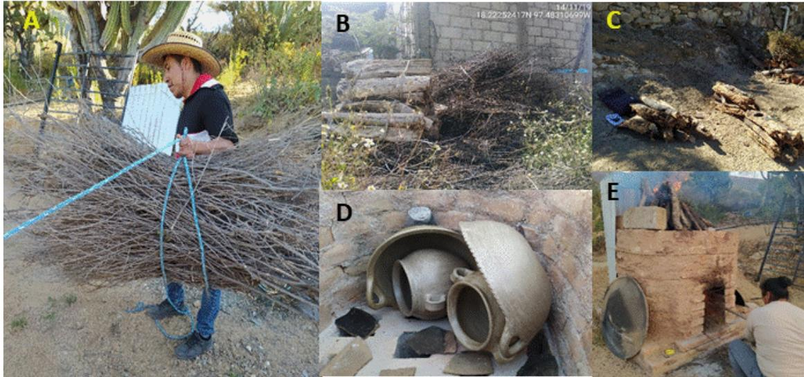
**Figura 17.** Leña usada en la alfarería. A: Rollo de popote seco (bofa). B: leña tapa (izquierda) leña bofa (derecha). C: Rollo de Izote (tapa). D: forma de acomodar las piezas dentro del horno. E: proceso de quemado de las piezas. (Fuente: Elaboración propia)
