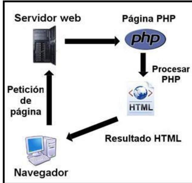
Figura 6.7 Esquema de operación del lenguaje PHP.
