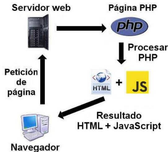
Figura 6.8 Diagrama de funcionamiento del lenguaje JS.
