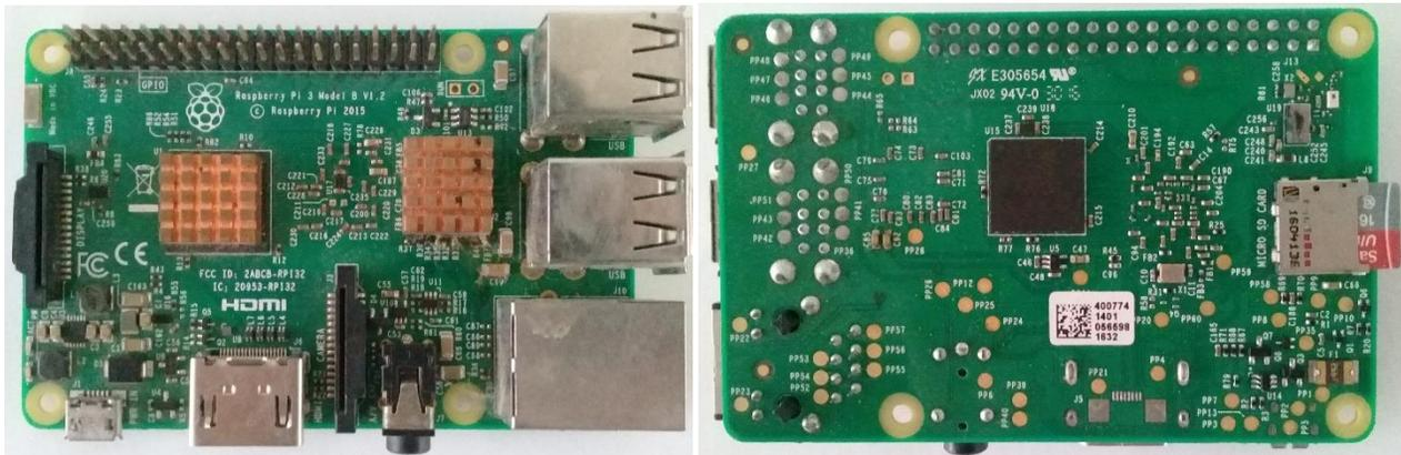
Figura 5. Vista frontal y posterior de Raspberry Pi 3B.
