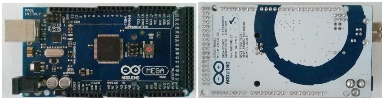
Figura 4. Vista frontal y posterior de Arduino Mega 2560.
