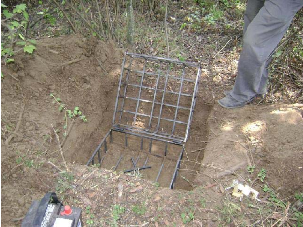
Figura 4. Sistema de protección en campo para los monitores continuos
