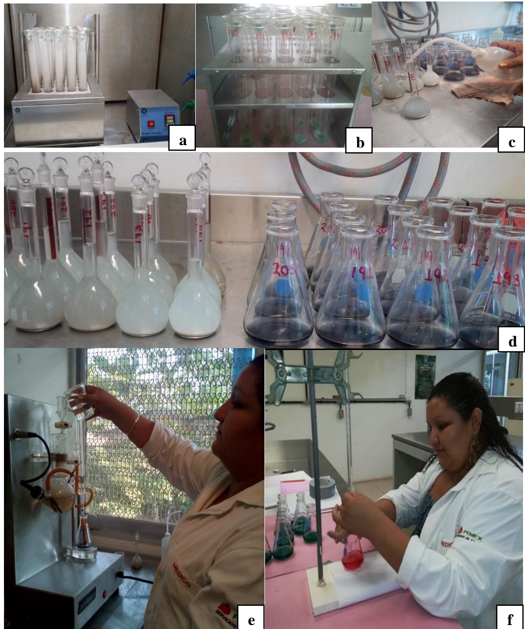
Figura 13. Nitrógeno total; a) Equipo micro-Kjeldahl, b) combustión de muestras a 340 °C, c) Extracto de la muestra aforada para destilar, d) extracto de muestra y ácido bórico con indicador para destilación, e) destilación, y f) titulación de muestras.
