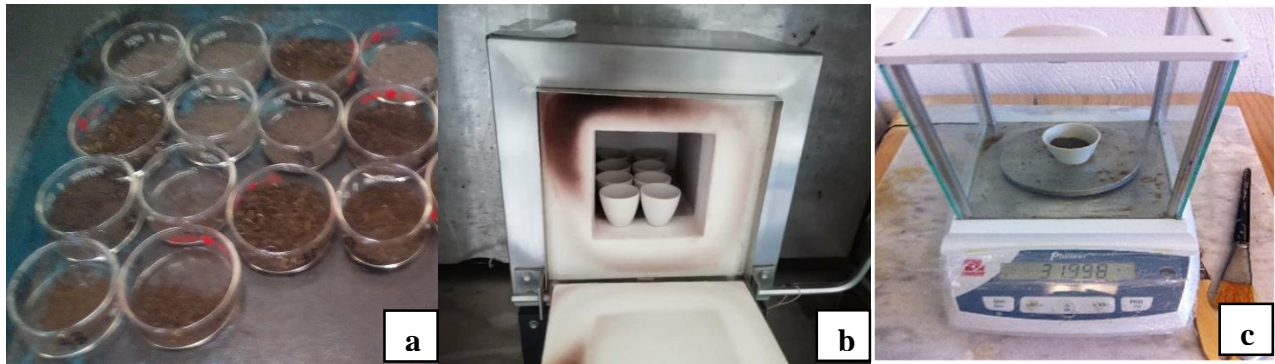
Figura 12. Carbono orgánico; a) Muestras secas, b) calcinación de muestras, y c) gravimetría de muestras calcinadas.
