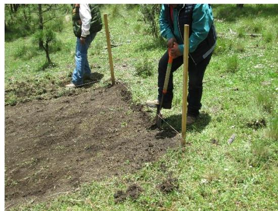
**Figura 3.9. Preparación e instalación de lotes de escurrimiento.**
