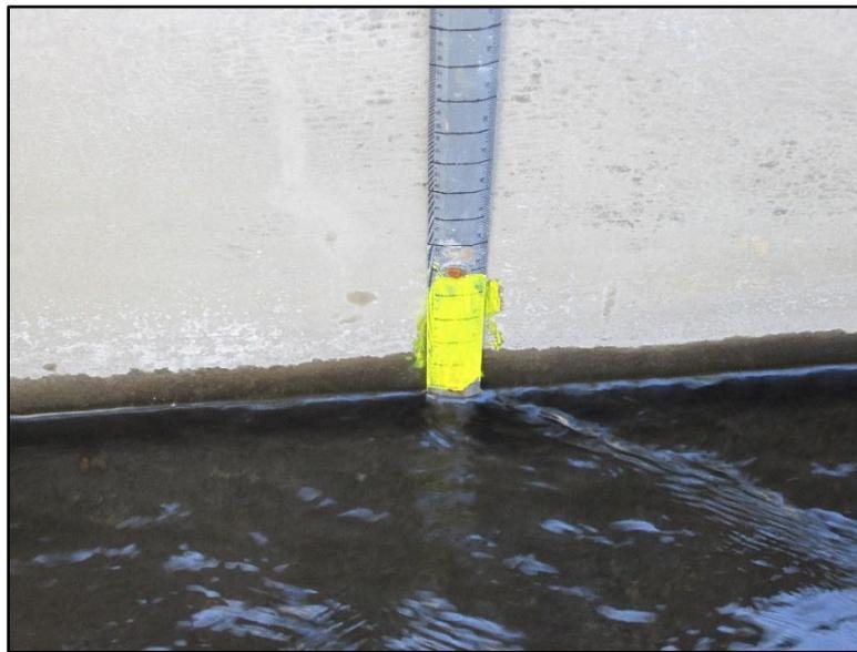
*Figura 3.20. Medición del tirante de agua en canal.*
