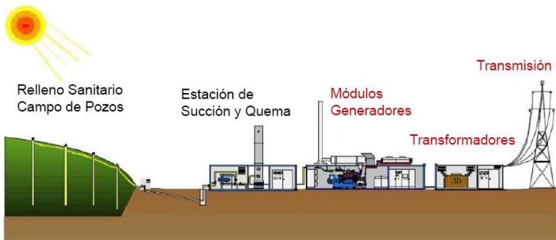
Figura 22. Descripción del proyecto de generación eléctrica con biogás. (Biogás, 2014)
