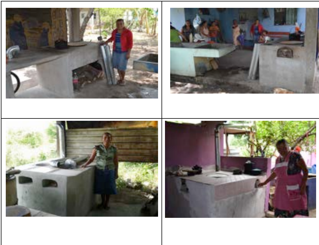
Figura 19 – Estufas con una entrada de leña, una cámara de combustión y dos quemadores (comales).
