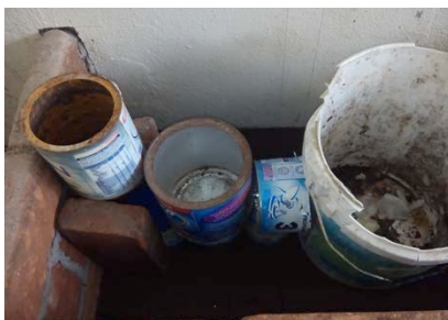
Figura 16 - Se usan cubetas y latas como moldes
