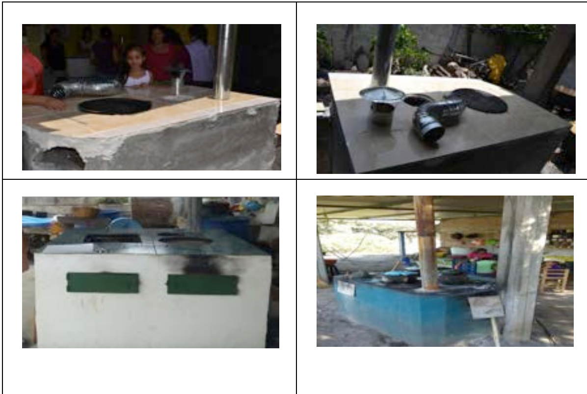
Figura 20 - Estufas con dos entradas de leña, dos cámaras de combustión y tres quemadores (comales).
