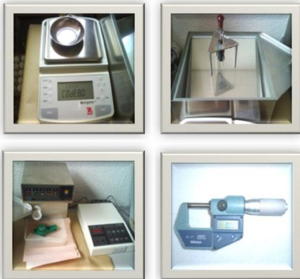
Figura 8. Aparato Egg Multi Tester (QCM System, Technical Services y Supplies, Dunnington, Reino Unido) y micrómetro
