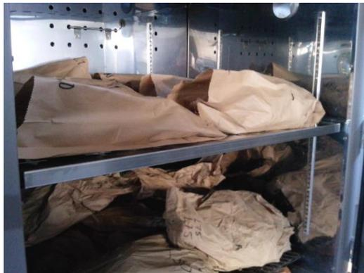
Figura 4.6. Obtención de materia seca en una estufa de secado.
