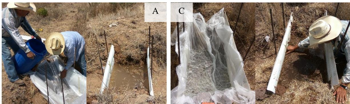
**Figura 22. Instalación de las secciones en las zanjas bordo de las parcelas A y C y medición de la velocidad de infiltración.**
