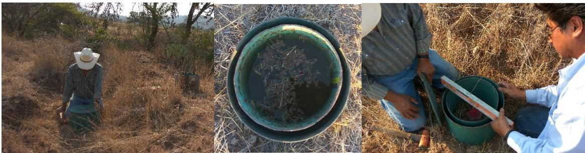
**Figura 21. Infiltrómetro de doble anillo y su instalación en campo.**
