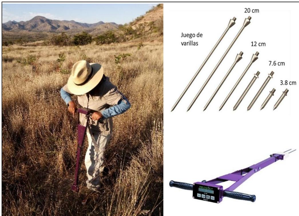
**Figura 18. Medición en campo del contenido de humedad, FieldScout TDR 300 y varillas.**
