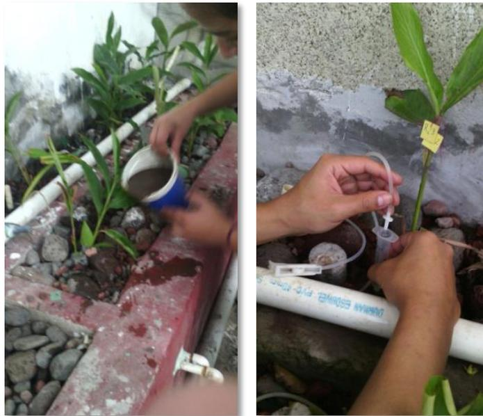
**Figura 10.** Vertido de sustrato biológico (izquierda) y medición de flujo para TRH (derecha).
