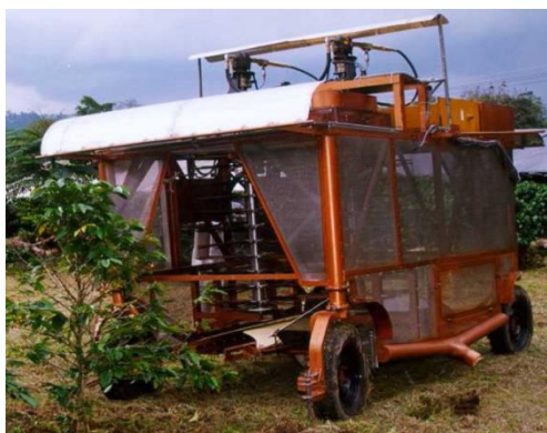
Figura 8. Prototipo CAVAUTO para cosechar café aplicando vibración al follaje, construido en CENACAFE (Oliveros et al. , 2005b).
