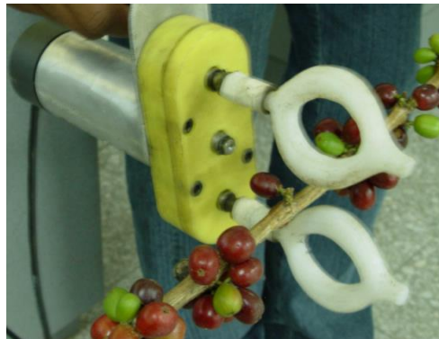
Figura 7. Actuador IMFRA-3DC, diseñado para la cosecha manual de café (Álvarez et al. , 2013).
