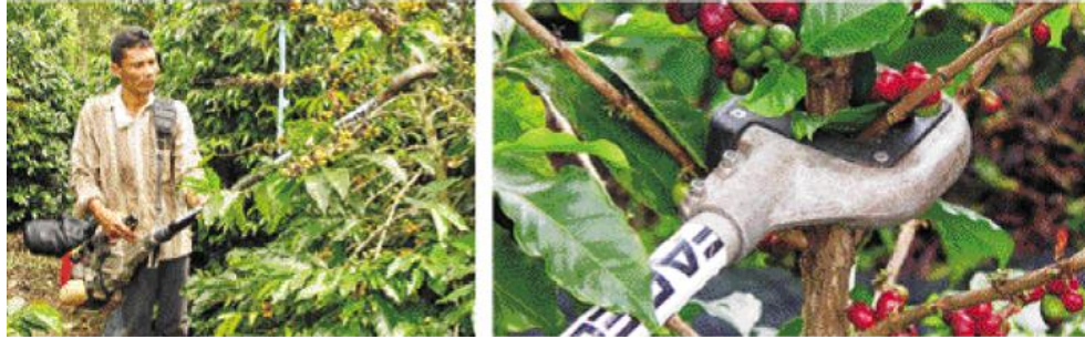
Figura 6. Vibrador portátil de tallo Cifarelli SC700®, vista general del equipo y acople de la lanza al tallo del cafeto (Oliveros et al. , 2005a).
