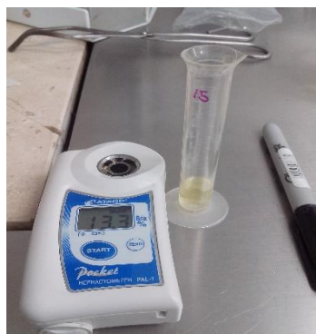
Figura 14. Refractómetro para medir grados Brix de las muestras de Volvariella bombycina (CP-675 y CP-733).
