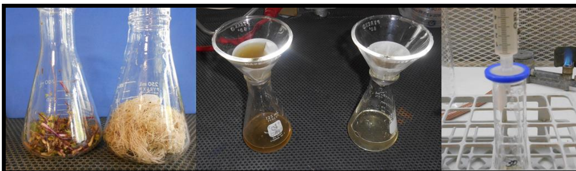
Figura 4. Proceso de obtención y filtrado de los lixiviados acuosos de la raíz y de la parte aérea de Ipomoea purpurea L. Roth.
