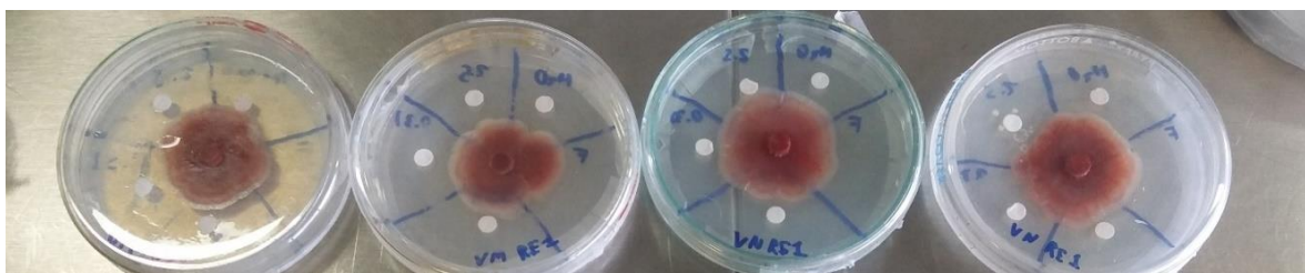
Figura 1.4. Cajas de Petri para la evaluación de la actividad antifúngica del extracto obtenido de plantas de P. luteoalbum inoculadas (dos cajas, lado izquierdo) y no inoculadas (dos cajas, lado derecho) con R. irregularis .
