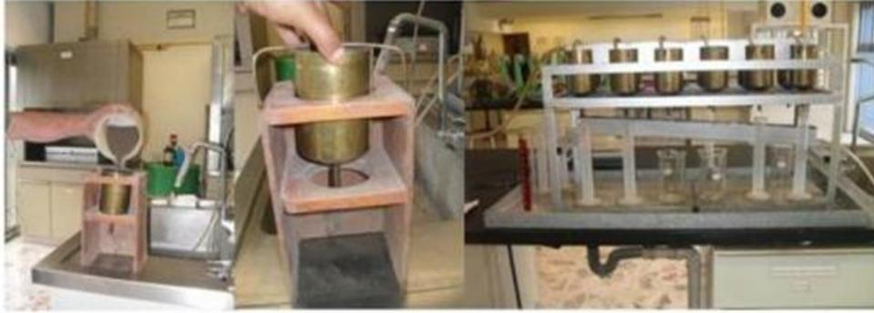
**Figura 26.** Estimación de la conductividad hidráulica de las muestras de suelo.
