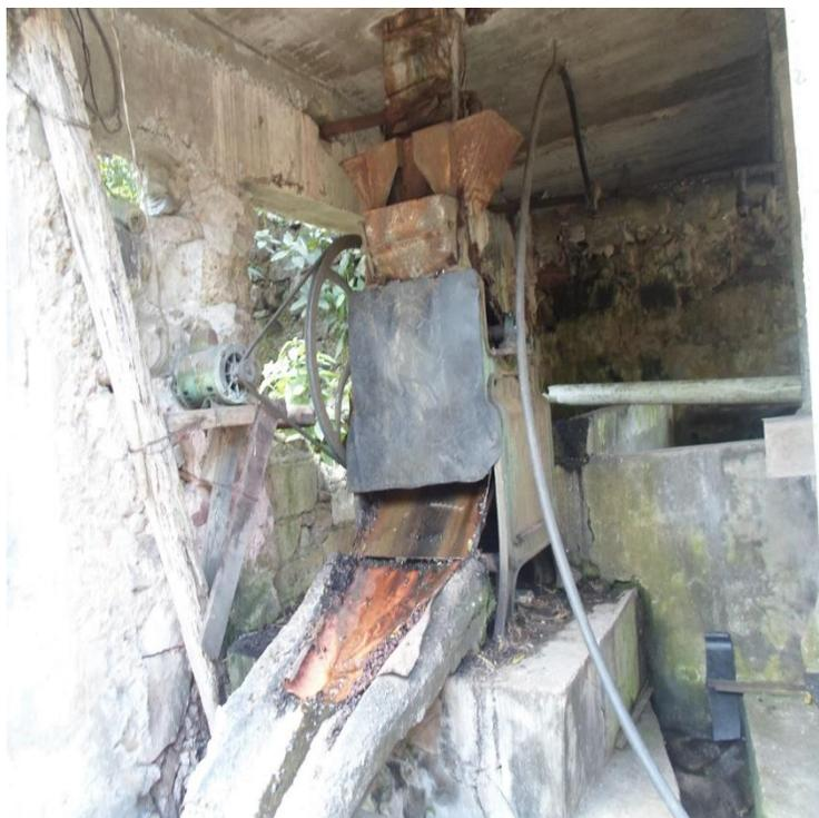
Figura 21. Máquina despulpadora. Fuente toma propia. 2015.
