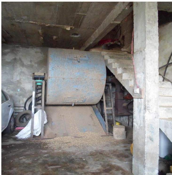
Figura 22. Secadora mecánica de café. Fuente toma propia. 2015.
