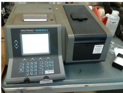
**Figura 5. Espectrofotómetro Spectronic® Genesys 5, utilizado para la determinación de compuestos fenólicos.**
