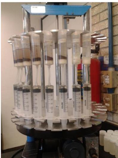
**Figura 4. Equipo de succión a vacío de cationes intercambiables.**
