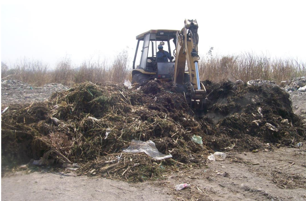
Foto 4 y 5. Método de humectación y aireación de las pilas de compostaje de los residuos provenientes del tianguis de la Ciudad de Atlixco. Semana 4 y 5 del proceso.
