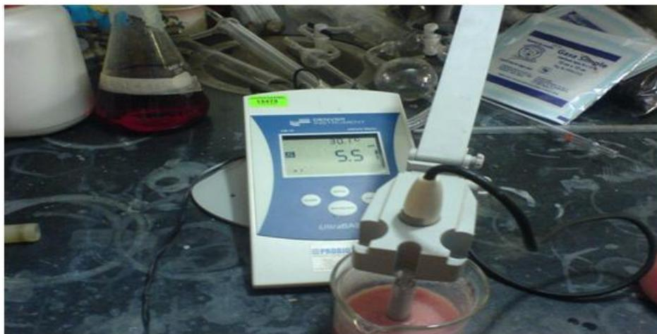
Figura 17. Medición del pH con un potenciómetro.
