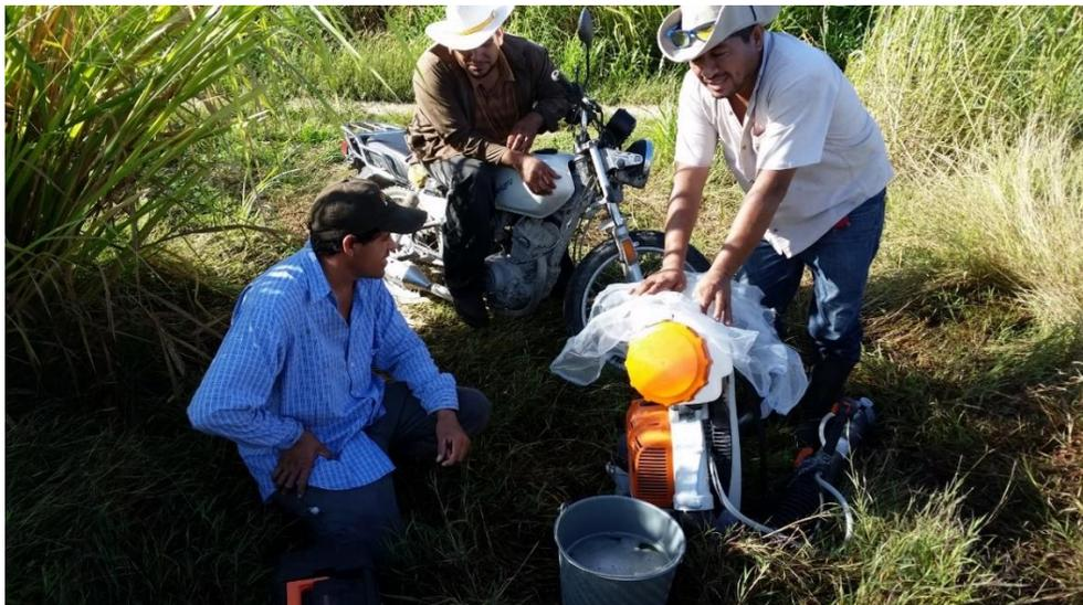
Foto 11. Bombas marca STHIL® modelo SR 450 de boquillas de ULV con malla provisional para evitar taponamiento por cascarilla de arroz lo cual afecta el funcionamiento de bomba aspersora.
