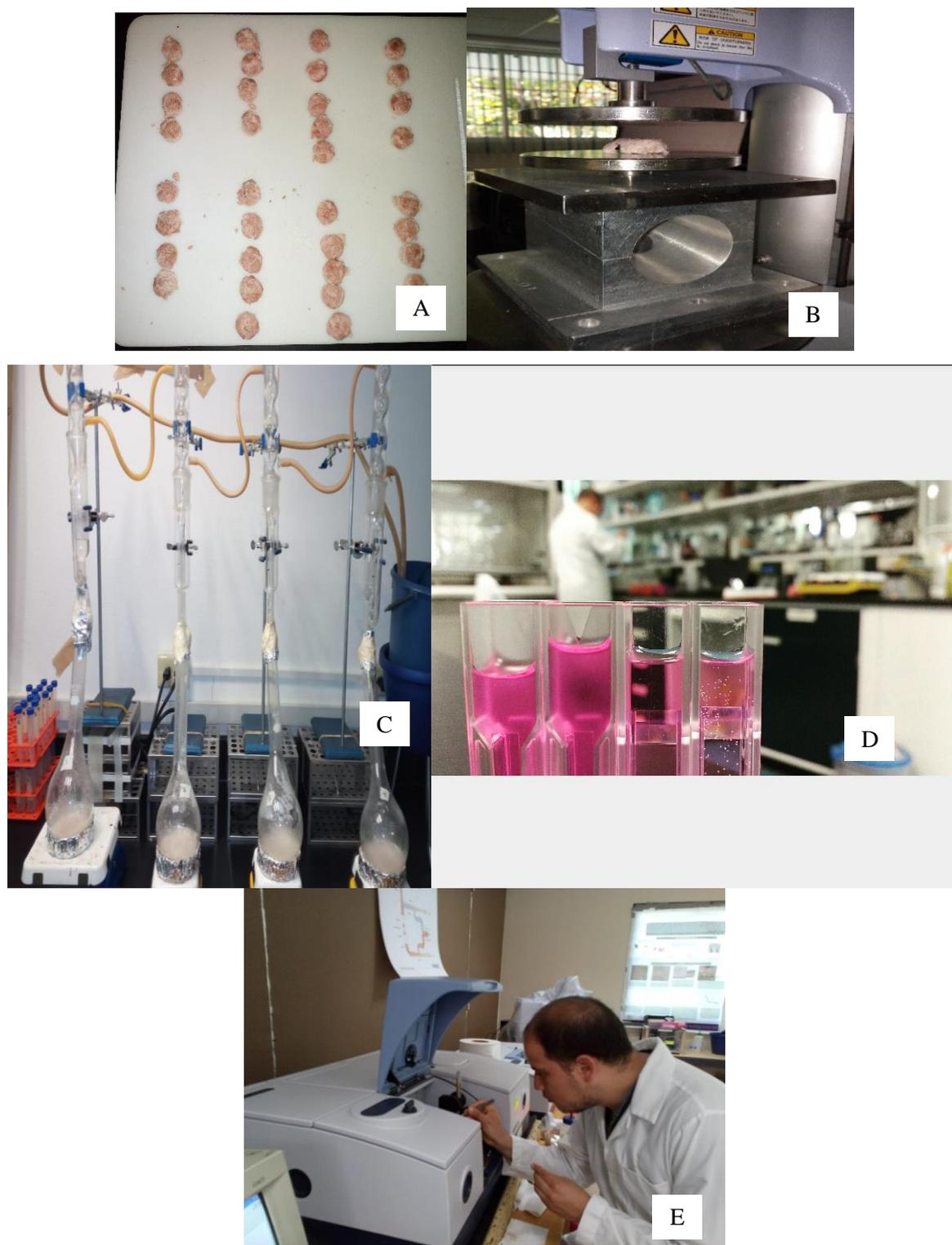
**Figura 4.** Cortes con sacabocados para análisis de perfil de textura (TPA) de las patties de carne de cerdo cocinada (A), TPA en texturómetro (B), análisis de TBAR por destilación, reacción colorimétrica: complejo ácido 2, tiobarbiturico – malondialdehído (D), análisis FTIR en modalidad ATR de las patties (E).
