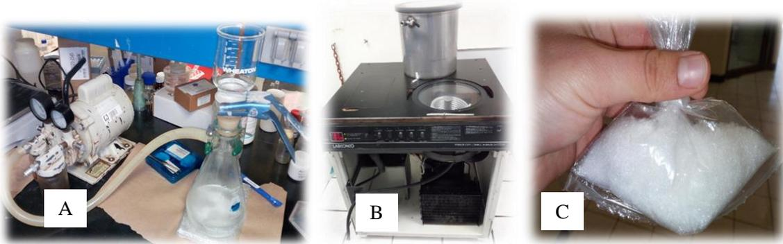
**Figura 1.** Filtración de (A), liofilización de (B) y biopolímero purificado (C).
