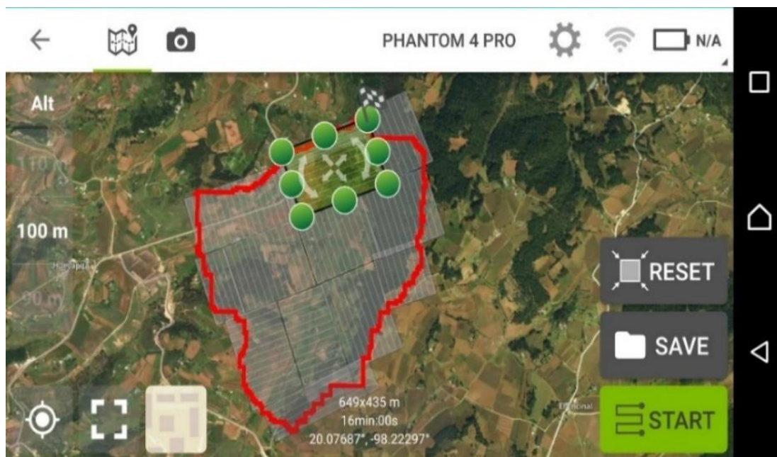
Figura 17. Programación de rutas de vuelo de la nano cuenca 9 La Mesa, Acaxochitlán, Hidalgo.
