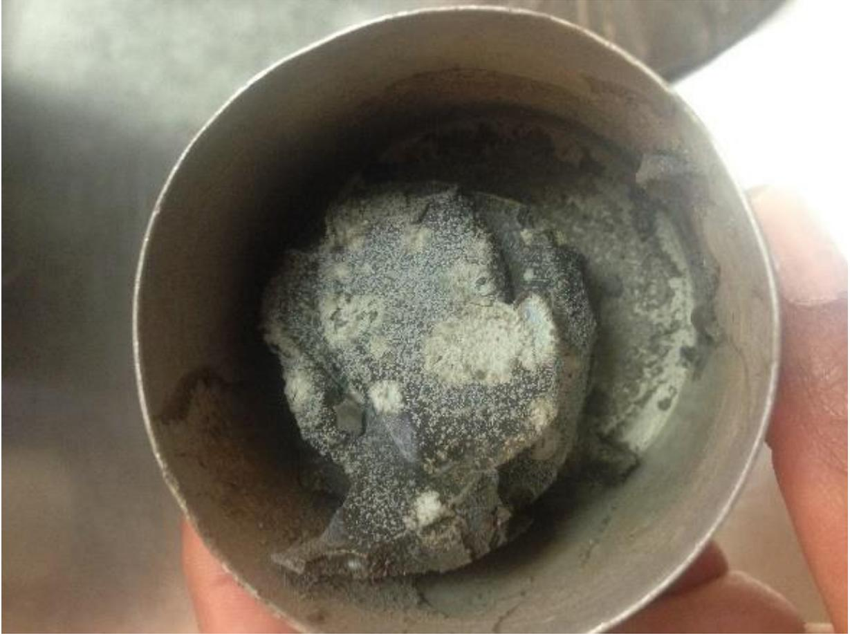
**Imagen 2.** Sedimento salino-sódico del ex lago de Texcoco, secado en estufa por 48 h.
