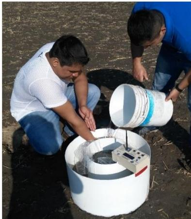
**Figura 4. 38.** Llenado de los cilindros concéntricos
