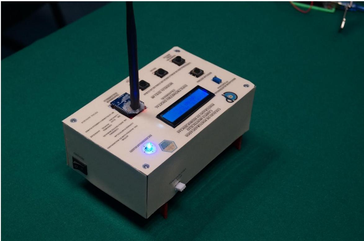
**Figura 9. 1.** Infiltrómetro digital modelo: IDX1.00 (Trasmisor).
