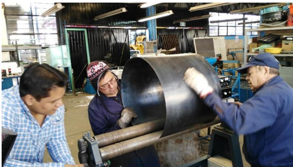
**Figura 4. 8.** Rolado de la placa de acero
