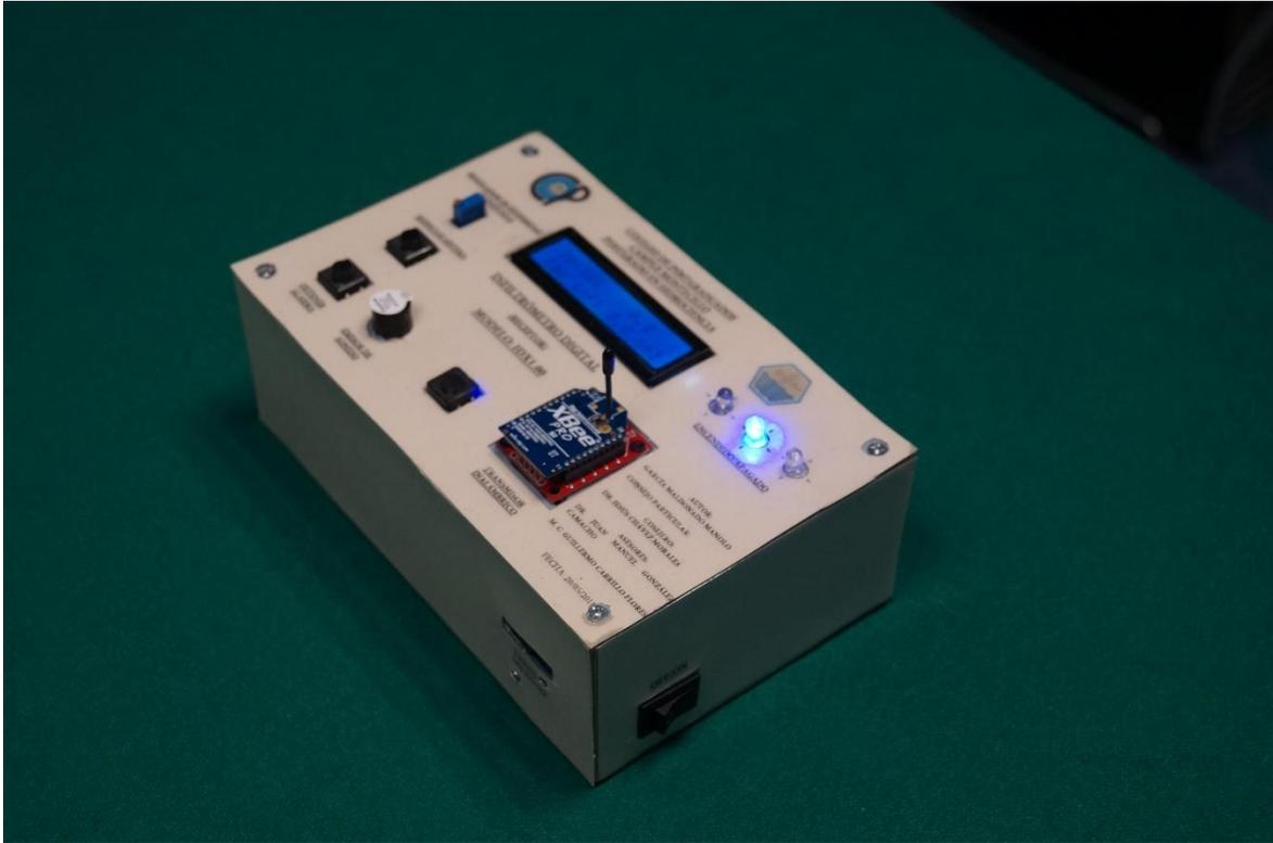
**Figura 9. 2.** Infiltrómetro digital modelo: IDX1.00 (Receptor).
