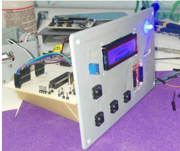
**Figura 4. 32.** Componentes en la tapa superior del gabinete.
