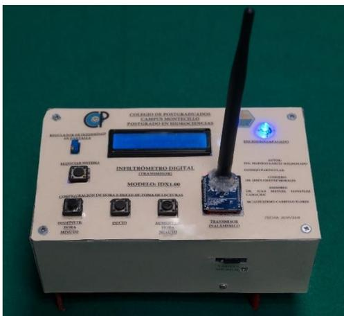
**Figura 4. 33.** Infiltrómetro digital emisor.
