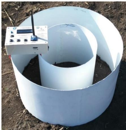
**Figura 4. 36.** Colocación del infiltrómetro digital transmisor.
