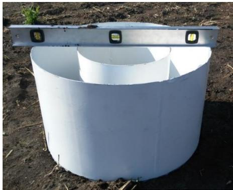
**Figura 4. 35.** Instalación de los cilindros concéntricos.
