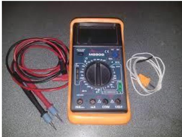
Figura 4. 26. Multímetro
