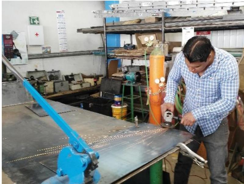
**Figura 4. 7.** Trazo y corte de la placa de acero.
