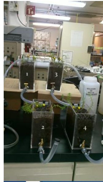
Figura 3.3a. Humedal artificial de flujo subsuperficial (HAFSS).
