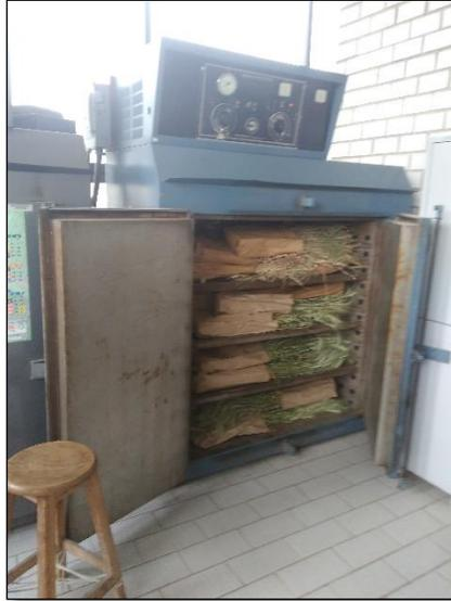
Figura 23. Secado de muestras en horno a temperatura constante.
