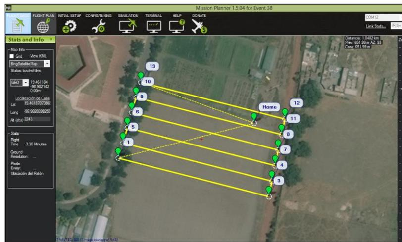
Figura 19. Plan de vuelo realizado con el software Mission Planner.
