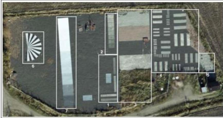
Figura 7. Campo de prueba permanente de Sjököulla, Finlandia junto con algunos objetivos portátiles suplementarios es un campo de prueba fotogramétrico prototipo (Fuente: Honkavaara *et al.*, 2008).
