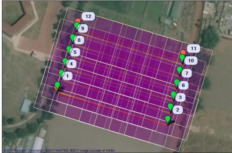
Figura 20. Arreglo del traslape frontal y lateral entre imágenes.
