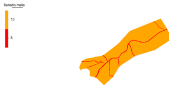
Figura 4.38. Tamaños de celda para las diferentes fronteras de los cauces y llanuras
