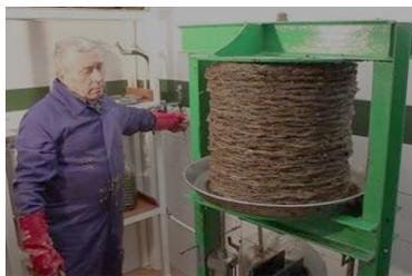
**Figura 2.** Extracción por prensado en frío.
