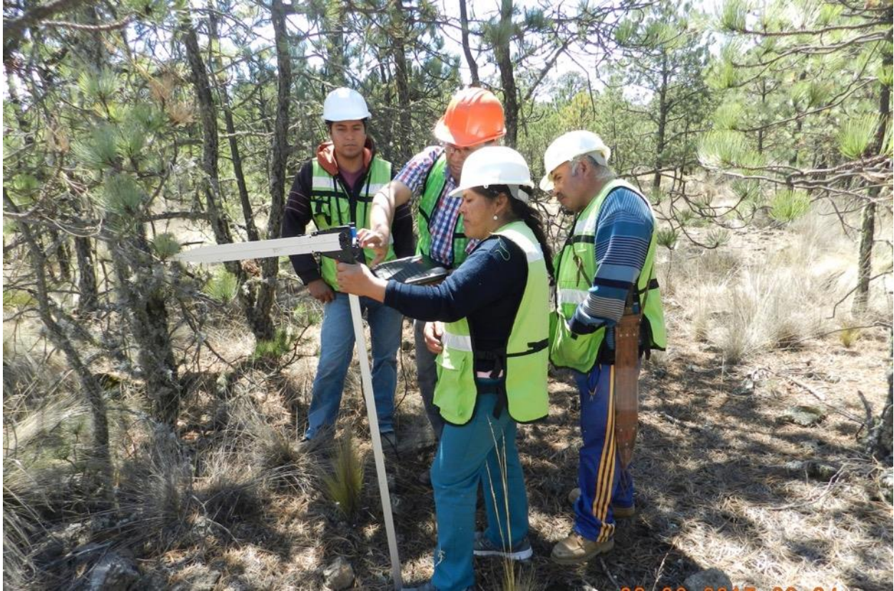
Figura 34. Forcípula electrónica Haglöf y sistema de control para la cubicación automática de madera en rollo.
