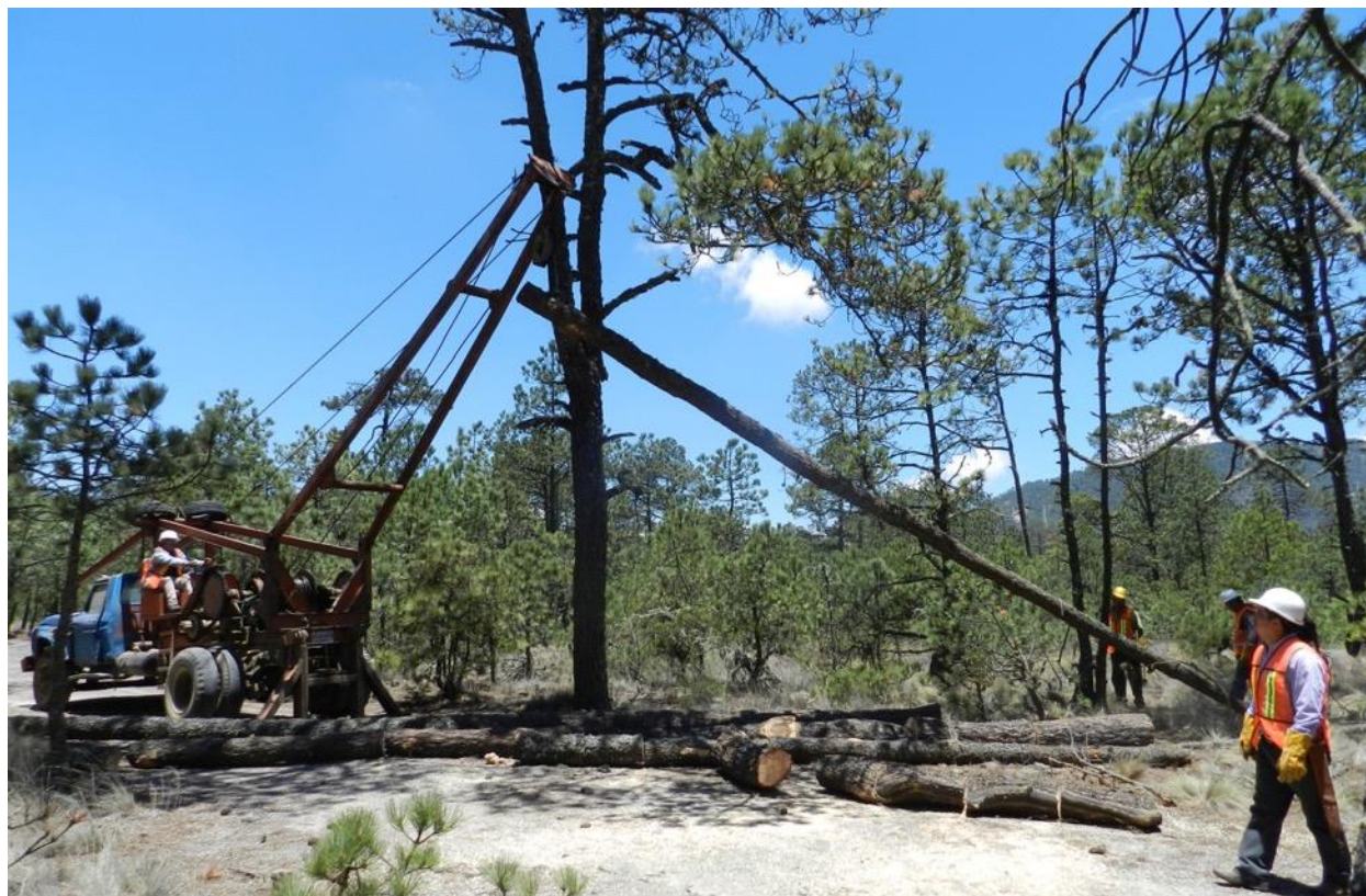
Figura 33. Arrime semi-suspendido del fuste limpio.
