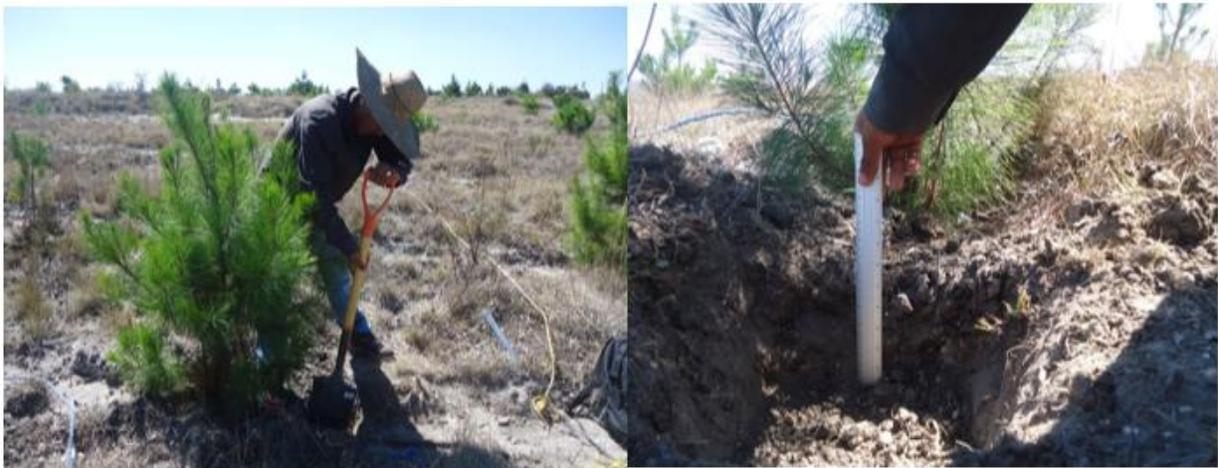
**Figura 14.** Toma de muestra de suelo a 10 cm de profundidad.
