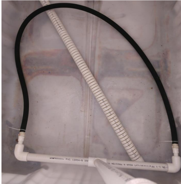
Figura 15. Línea de aireación del contenedor de peces.
