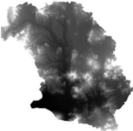
Cargado el DEM en ArcGIS se selecciona de la barra de herramientas la opción **Terrain processing>Dem manipulation>Fill Sinks** con este proceso se llena los huecos que pudieran existir en el GRID, como resultado se obtiene un archivo ráster llamado "fil".
