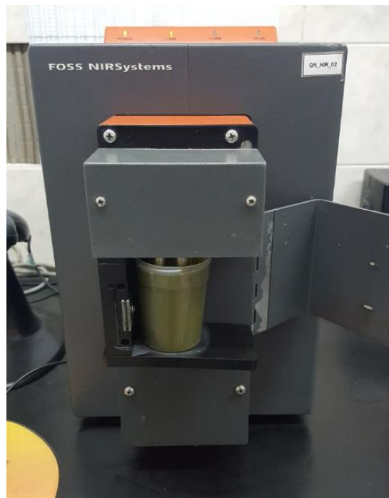
Figura 10. Colocación correcta de la celda con muestra para medición en el equipo NIR.
