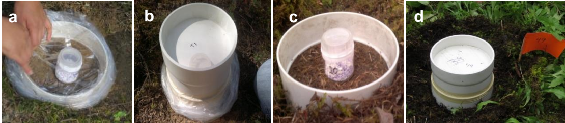
Figura 2.4. Cámaras de PVC para determinación de CO 2 en Abies religiosa : (a) frasco con cal sodada del testigo, (b) cámara sellada del testigo, (c) frasco con cal sodada de la muestra y (d) cámara sellada de la muestra.
