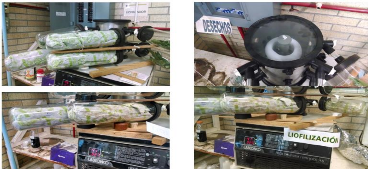
Figura 4.2. Liofilizado de la muestras de la diferentes fases del proceso de compostaje.
