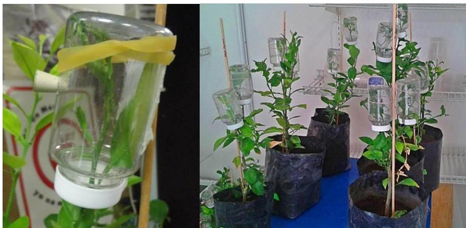
**Figura 4.1** Dispositivo usado en los bioensayos con el parasitoide *Tamarixia radiata*.
